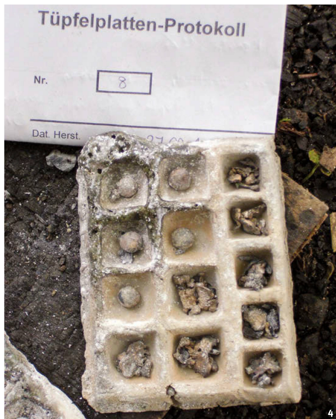
Abb. 4 Für die Vorversuche verwendete Tüpfelplatte mit kugelförmigen Schrötlingen (links) und starker Verschlackung.
