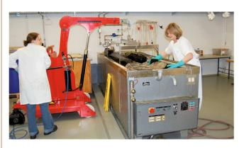
Für die Konservierung von Nassholz werden bis zu 7 PEG-Bäder in steigenden Konzentrationen eingesetzt. Die Bäder wurden regelmässig kontrolliert und erneuert, wenn durch mikrobakteriellen Befall die Lösung zu stark gesättigt war.
