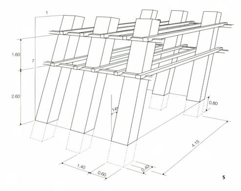
Fig. 5 Vue schématique et dimensions du rempart d'Yverdon-les-Bains.
