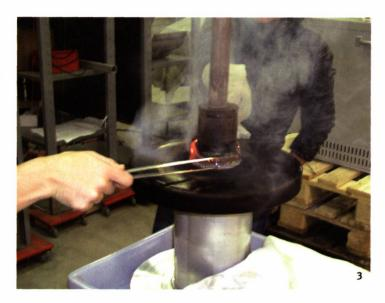
Abb. 3 ...und kann in einem weiteren Schritt mit einer Pinzette profiliert werden.
