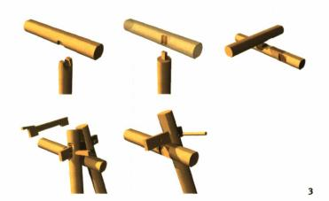
Fig. 3 Système de fixation en T: à enfourchement ou à tenon et mortaise. OMAN. Infographie: J. Roethlisberger.
