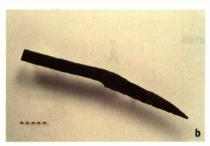
Le coutre, semblable à un grand couteau recourbé, se compose d'une barre de section rectangulaire constante et d'une sorte de lame allongée. Il est fixé dans le timon, devant la reille ou le soc, car il «coupe la terre compacte avant qu'elle soit ouverte, et dessine les futurs sillons, en faisant des incisions sur lesquelles mordra, en labourant, le soc couché à plat.» (Pline l'Ancien, Histoire naturelle, XVIII, 171).\_C. A.
