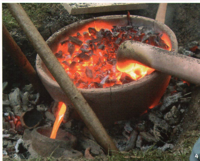
Abb. 3 Die Befeuerung des Tiegels erfolgt mit Holzkohle und Luftzufuhr über vier mit Blasbälgen betriebene Düsen.
