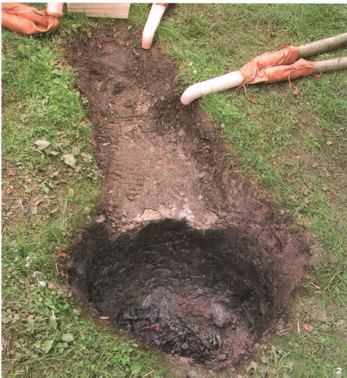
Abb. 2 Die Giessgrube besteht aus einem tieferen Teil für die Gussform und einem flacheren Teil, wo der Tiegel platziert wird.
