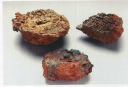
Fliessschlacken: typische Rückstände von der Eisenerzverhüttung in einem Rennofen. Chevenez-Lai Coiratte.
