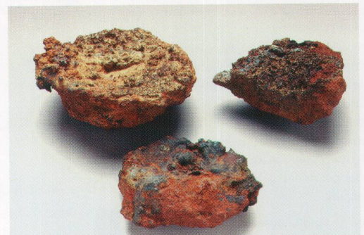
Fliessschlacken: typische Rückstände von der Eisenerzverhüttung in einem Rennofen. Chevenez-Lai Coiratte.
