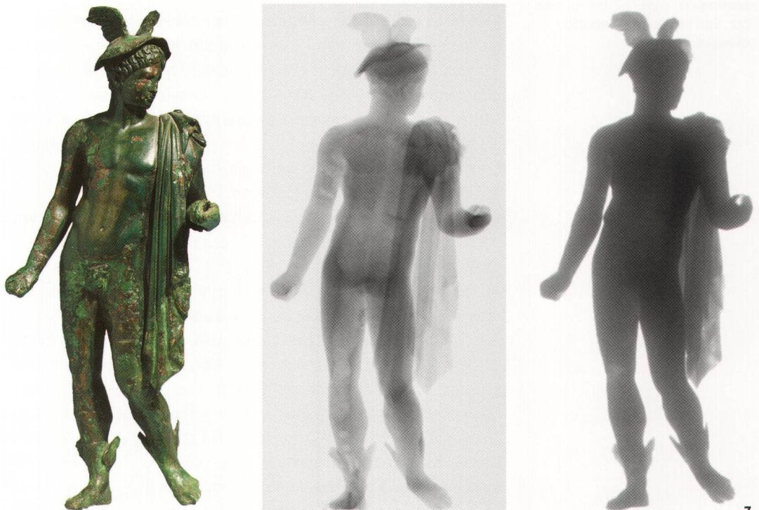
Abb. 7 Ansichten des Merkur von Thalwil (Abb. 2), wie sie sich mit unterschiedlicher «Belichtung» ergeben. Links: Foto bei Naturlicht, Mitte: Neutronenradiographie, rechts: Röntgenradiographie. Höhe der Statuette 22,5 cm.
