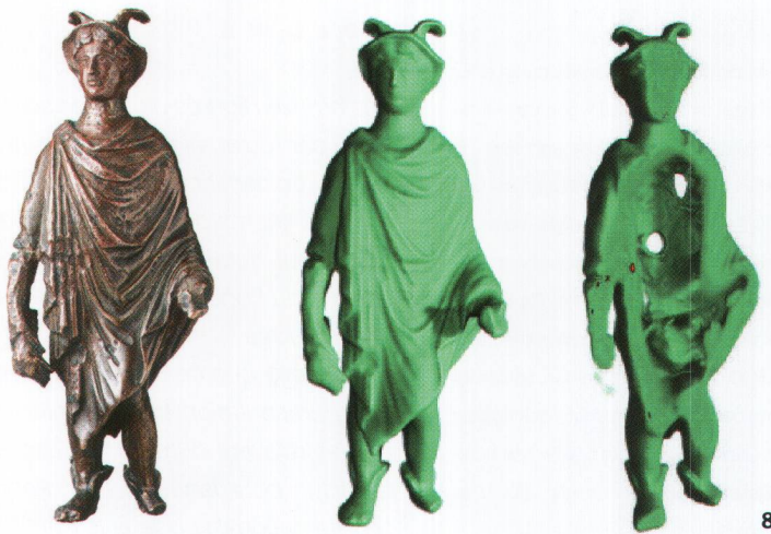
Abb. 8 Der Merkur von Uster (Abb. 3) als Foto (links), Tomographieansicht der Aussenkonturen (Mitte), und im Schnitt durch das Objekt, erzeugt mit Hilfe von numerischen Verfahren aus dem Tomographiedatensatz (rechts).
