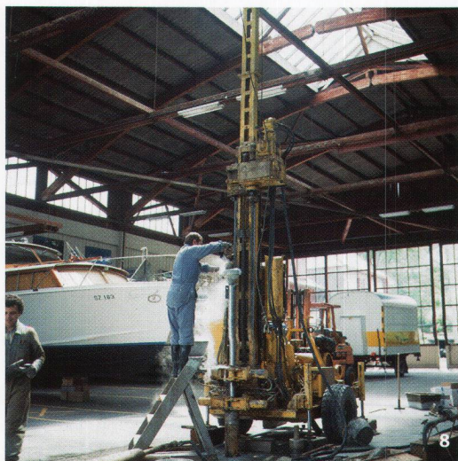
Abb. 8 Trockeneis-Sondierung in der Werfthalle, welche über dem neolithischen Siedlungsplatz Horgen- Scheller ZH liegt.
