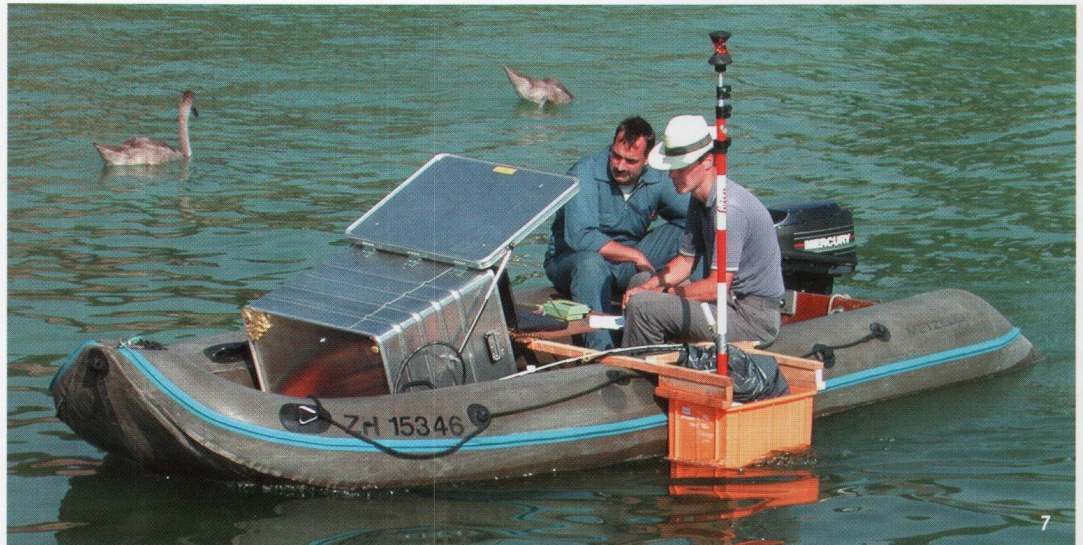
Abb. 7 Hightech auf dem Schlauchboot: Georadarmessungen über der Uferplatte in Kilchberg ZH.
