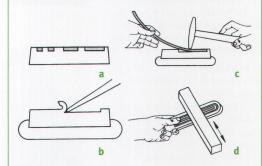
Ricostruzione schematica della lavorazione ad agemina.
