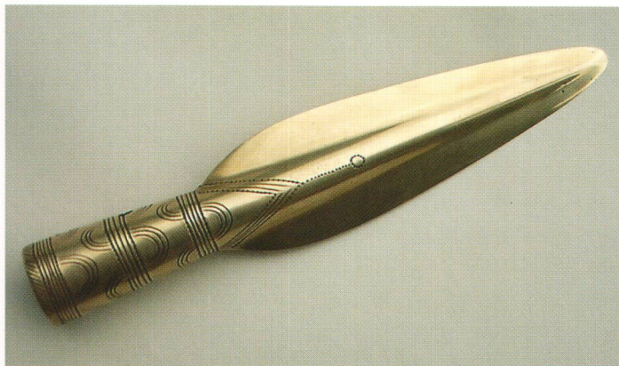
Abb. 6 Fertig bearbeitete Lanzen Spitze. Die Schneiden wurden überhämmt, die ganze Spitze überschleift und zise- liert.
