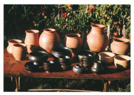
Abb. 3 So präsentiert sich die Brennladung nach dem Öffnen der Einsetztüre.
