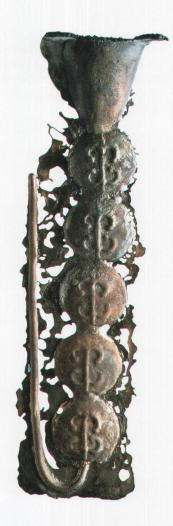
in ungebrannten Ton keinerlei Probleme darstellt. Mehr als fünf Münzen untereinander in einem Gussvorgang zu giessen ist sicher möglich. Die Länge der Gussform wird durch die Erstarrung des Metalls diktiert, welche mit Vorheizen der Gussform hinaus gezögert werden kann.
