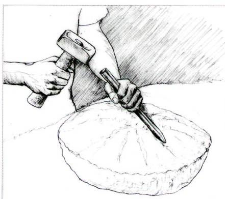
fig. 14 Étape de façonnage d'une meta. Dessin A. Pulido. Arbeitsschritt beim Zurichten eines Bodensteins. Una tappa della lavorazione di una meta.
