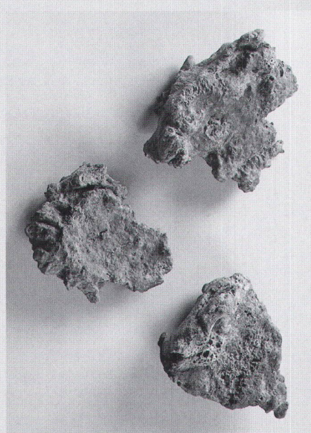
fig. 14 Scories en calotte, formées au fond du foyer de forge par accumulation de matières fondues (L. env. 8 cm). Photo C. Zaugg. Kalottenschlacke, entstanden durch das Zusammenfließen der Schlacke am Boden der Feuerstelle. Scorie a forma di calotta, venutesi a formare sul fondo del focolare di fucina per accumulazione di particelle fuse.
