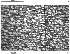
Abb. 8 Mikroskopische Querschnittaufnahmen von Pfaffenhütchen (a) und Pappel (b). Die beiden Arten unterscheiden sich aufgrund ihrer holzanatomischen Merkmale sehr deutlich voneinander (Photos W. Schoch, Labor für Quartäre Hölzer).
