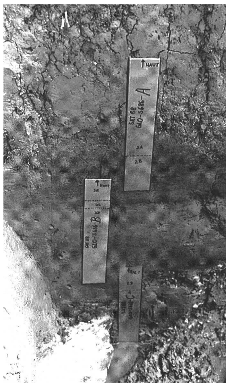
fig. 4 Prélèvements de sédiments aux fins des analyses sédimentologiques et palynologiques au moyen de boîtes en aluminium à profil en U. Sedimentprobenentnahme für sedimentologische und palynologische Untersuchungen. Prelevamento di sedimenti per analisi sedimentologiche e palinologiche.
