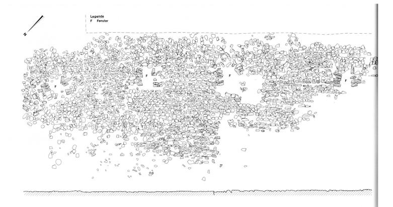
Abb. 12 Steingerechte Zeichnung der im Stück verstürzten Südwand von Bau 10 mit hochrechteckigen Fenstern mit Tuffgewänden. Als Sturz diente ein Holzbalken. Zeichnung Ursula Wapp.
