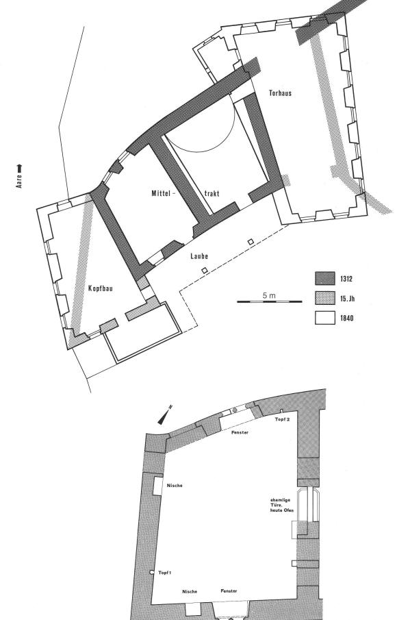
Abb. 8 Grundriss des Festsaals im 1. Obergeschoss. Plan de la salle de fextes du premier étage. Pianta della sala festiva al primo piano.
