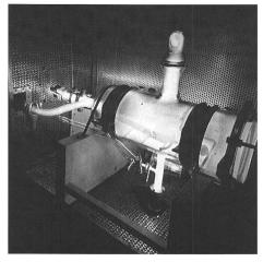
Abb. 1 Ein Schweizer Dolch (Länge ca. 40cm) während der Behandlung in einer Hochfrequenzentladung in Wasserstoff. Die Hochfrequenzspannung wird an die um das Glasrohr gewickelten Elektroden angelegt. Foto ACI, Univ. Zü-
