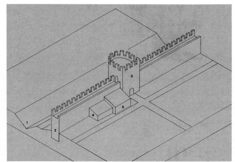
Schematischer Rekonstruktionsversuch. 1 Kastellgraben (bis heute nicht erforscht); 2 Kastellmauer; 3 Turm V; 4+5 an die Kastellmauer gelehnte Gebäude. Reconstitution de l'enceinte avec la tour V, le fossé, et les bâtiments intérieurs. Ricostruzione del muro della fortezza con la torre V, il fossato e le due case addossate nell'interno.
