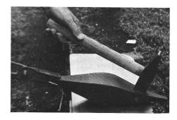
nach der Entnahme aus dem Rennofen, wodurch sich eine weitere Erwärmung auf Schmiedehitze erübrigte.
