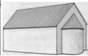
saales; dieser mass in der Breite aussen 6,60m, die Länge muss zwischen 10 und 11,70m betragen haben. Im Osten war die um Mauerstärke von 0,80 bis 0,85m eingezogene Apsis mit einem äusseren Radius von 2,50m abgeschlossen.
