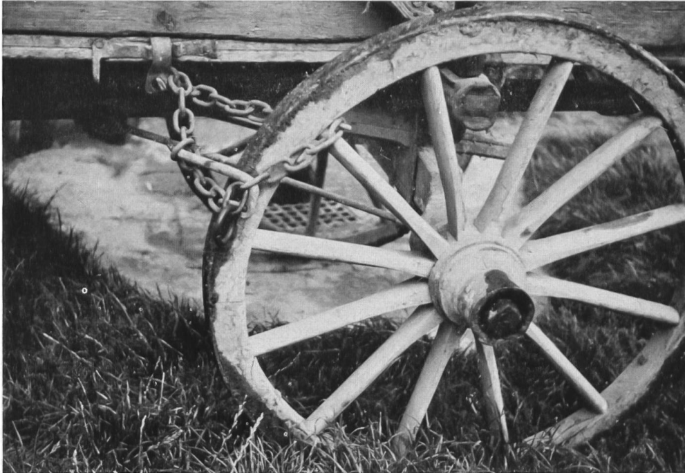
Abb. 36. Ptuj-Pettau, Jugoslawien. Wagenrad mit Kettenblockierung. Photo Laur.
