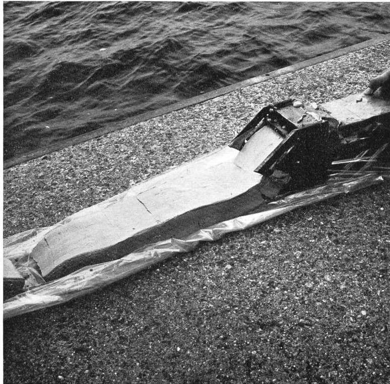
Abb. 52. Spitze der Sonde und ausgelassene Bodenprobe. Photo A. Och, Zürich.
