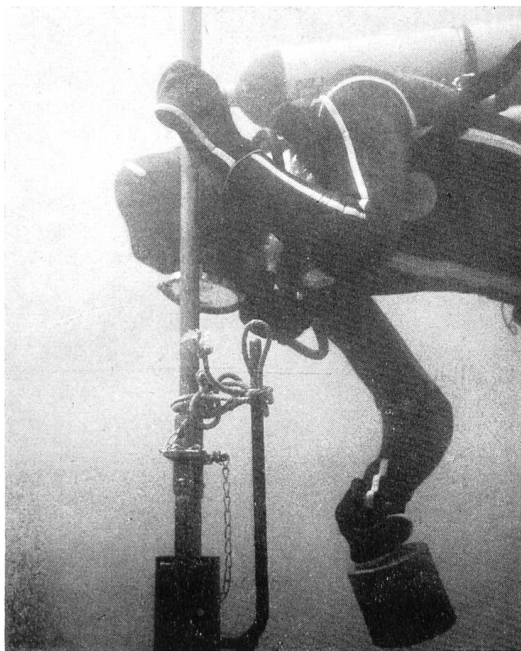
Abb. 49. Aufsetzen der Bodensonde.
