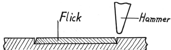
Abb. 21. Die Technik des Flickens. Die Skizze ist schematisch und nimmt auf wirkliche Abmessungen keine Rücksicht. Aus zeichnerischen Gründen ist auch die konische Fuge zwischen Grundmetall und Flick übertrieben dargestellt.
