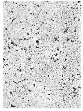
Abb. 22. Augst. Fragment aus Bronze, Inv. Nr. 61.2153. Mikrostruktur: Leicht gerichtetes Gefüge mit zahlreichen kleinen, schlackenartigen Einschlüssen. (Beide Aufnahmen sind ¾ der 75-fachen linearen Vergrößerung).
