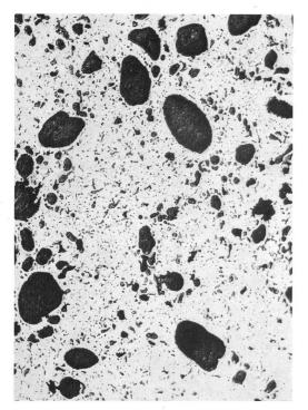
Abb. 23. Augst. Fragment aus Bronze, Inv. Nr. 61.2204. Mikrostruktur: Gußgefüge mit größeren Einlagerungen elementaren Bleis. Ausführung: Metallwerke AG. Dornach, Abteilung für Metallographie.
