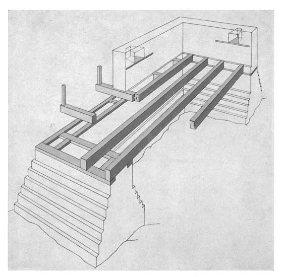
Abb.71. Rekonstruktion der Balkenlagen. Der Umgang ist problematisch (vgl. S.65); es sind zwei Lösungen angedeutet. Zeichnung Max Martin.
