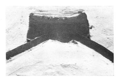
Abb. 85. Querschnitt durch die Naht, vergrößert.
