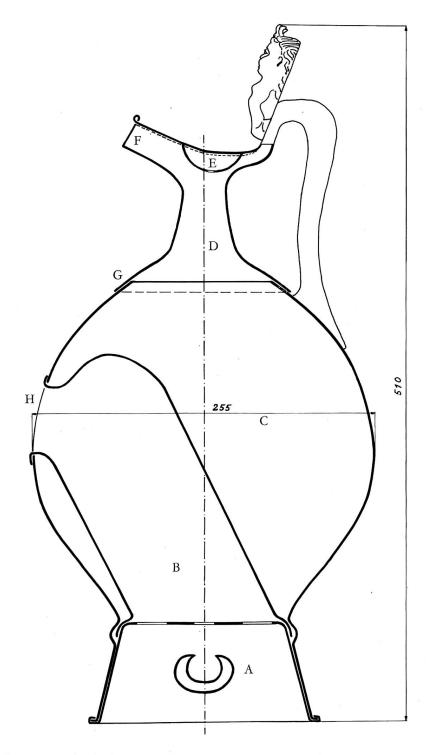
Abb. 27. Querschnitt durch die Authepsa. A = Innerer Teil des Fußes mit Rost und Luftdurchlässen. B = Heizrohr. C = Raum für die Flüssigkeit. D = Hals. E = Einguß mit Sieb. F = Ausguß. G = Verlötung von Gefäß und Hals. H = Öffnung des Heizrohres. In der Zeichnung ist das Heizrohr um 90° verdreht, in Wirklichkeit ist die Öffnung H gegen den Betrachter gerichtet. Maße in Millimeter. Zeichnung A. Mutz.
