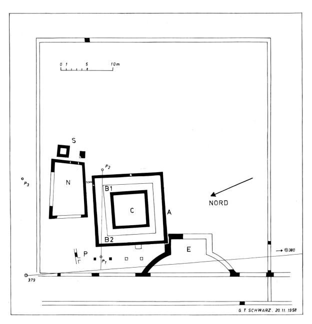
Abb. 3. Augst, Sichelen. Gallorömischer Tempel, Grundriß. – Legende: A = Außenmauer; B 1 = Mörtelboden, Bauperiode I; B2 = Mörtelboden II; C = Cella; E = nischenartige Erweiterung in der Hofmauer; N = Nebengebäude (Priesterhaus?); P = Porticus; p 1, 2, 3 = Meßpunkte; S = gemauerte Sockel.
