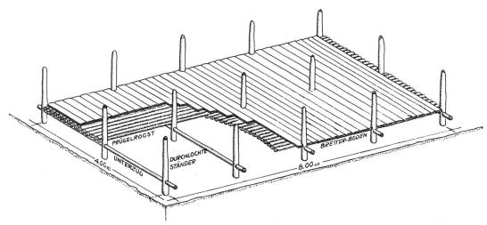
Abb. 26. Thayngen, SH, Weier 1956. Konstruktionsschema der Siedlung I.
