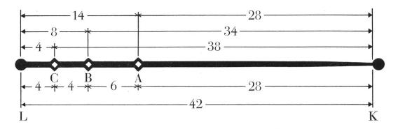
Abb. 27. Römische Schnellwaage. Proportionen des Waagebalkens. (Zahlen = digiti; 1 digitus =18,5 mm)
