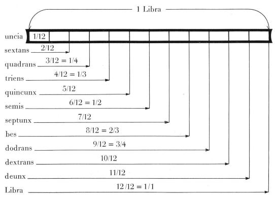
Abb. 29. Römische Schnellwaage. Die Einteilung des römischen Pfundes. (1 röm. Pfund = 327,45 gr.)
