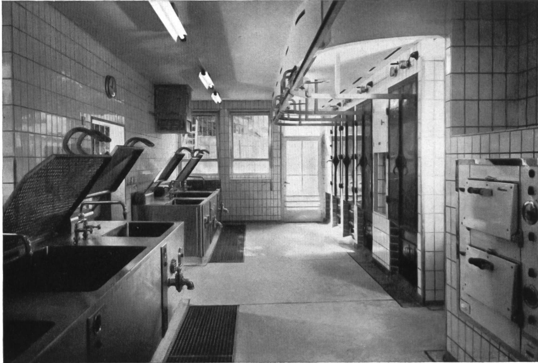
Abb. 28. Moderne Wursterei (Laub AG., Kleinbasel). Links die Kochkessel, rechts die Räucherkamern. (Photo Eidenbenz, Basel.)
