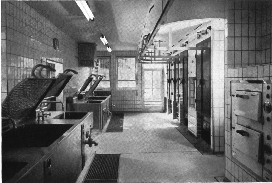
Abb. 28. Moderne Wursterei (Laub AG., Kleinbasel). Links die Kochkessel, rechts die Räucherammern. (Photo Eidenbenz, Basel.)
