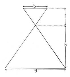
Abb. 45. Luftbild. Vertikalschnitt einer Senkrechtaufnahme.
