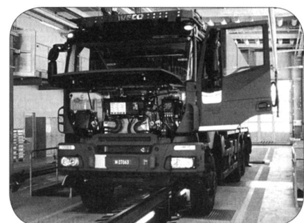
Der IVECO Traktor 450, Nachfolger der in die Jahre gekommenen Saurer Lastwagen – auf dem Prüfstand im ALC-O. (Fotos o-mag)
