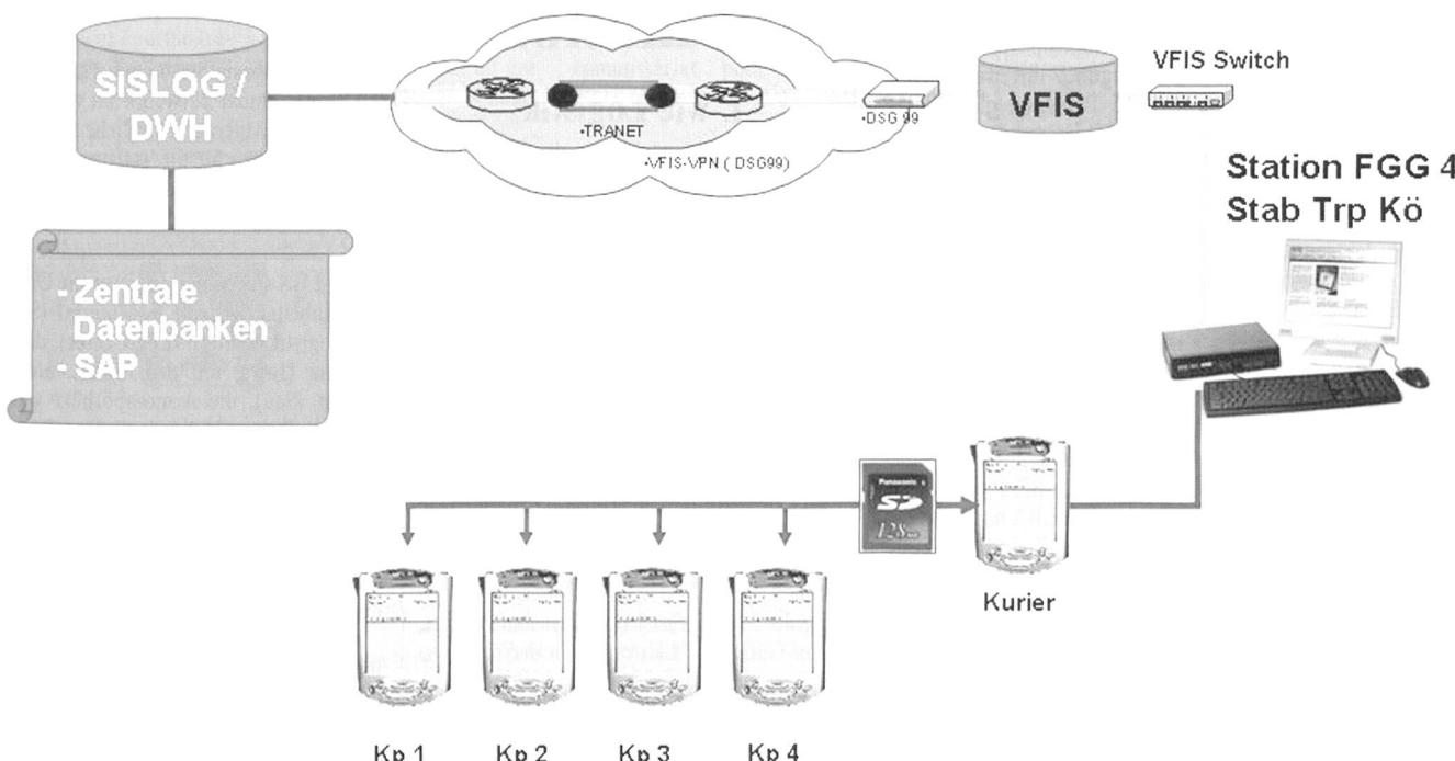
Die benötigten Daten werden über standardisierte Schnittstellen aus dem SAP in das Dataware-House von SISLOG (Strategisches Informationssystem Logistik) übernommen. Von dort gelangen sie dann via Tranet (Transparentes Datenkommunikationsnetz) ins VFIS (Versorgungs-Führungsinformationssystem) und mittels Desktop-Stationen auf Stufe Truppenkörper an die PDAs (Persönlicher Datenassistent) der Kompanien.
