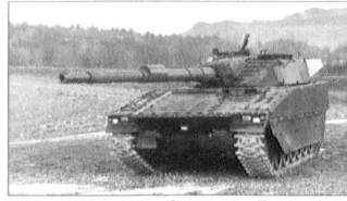
120 Millimeter «Compact Tank Gun» (CTG) für 25-Tonnen-Kampfschützenpanzer (hier aufgebaut auf Fahrgestell «CV 90» von Hägglunds, Schweden); eine Neuentwicklung der SW Schweizerische Unternehmung für Waffensysteme, Thun. Foto: RUAG SUISSE
