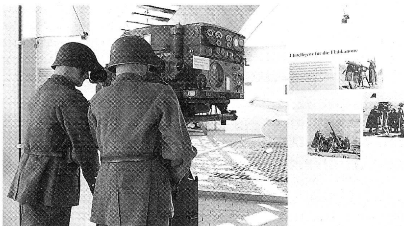
Handbedientes Flabkommandogerät, sog. Geschützvorhalterechner der Firma Gama, Ungarn, für die 7,5 cm Flabgeschütze.
