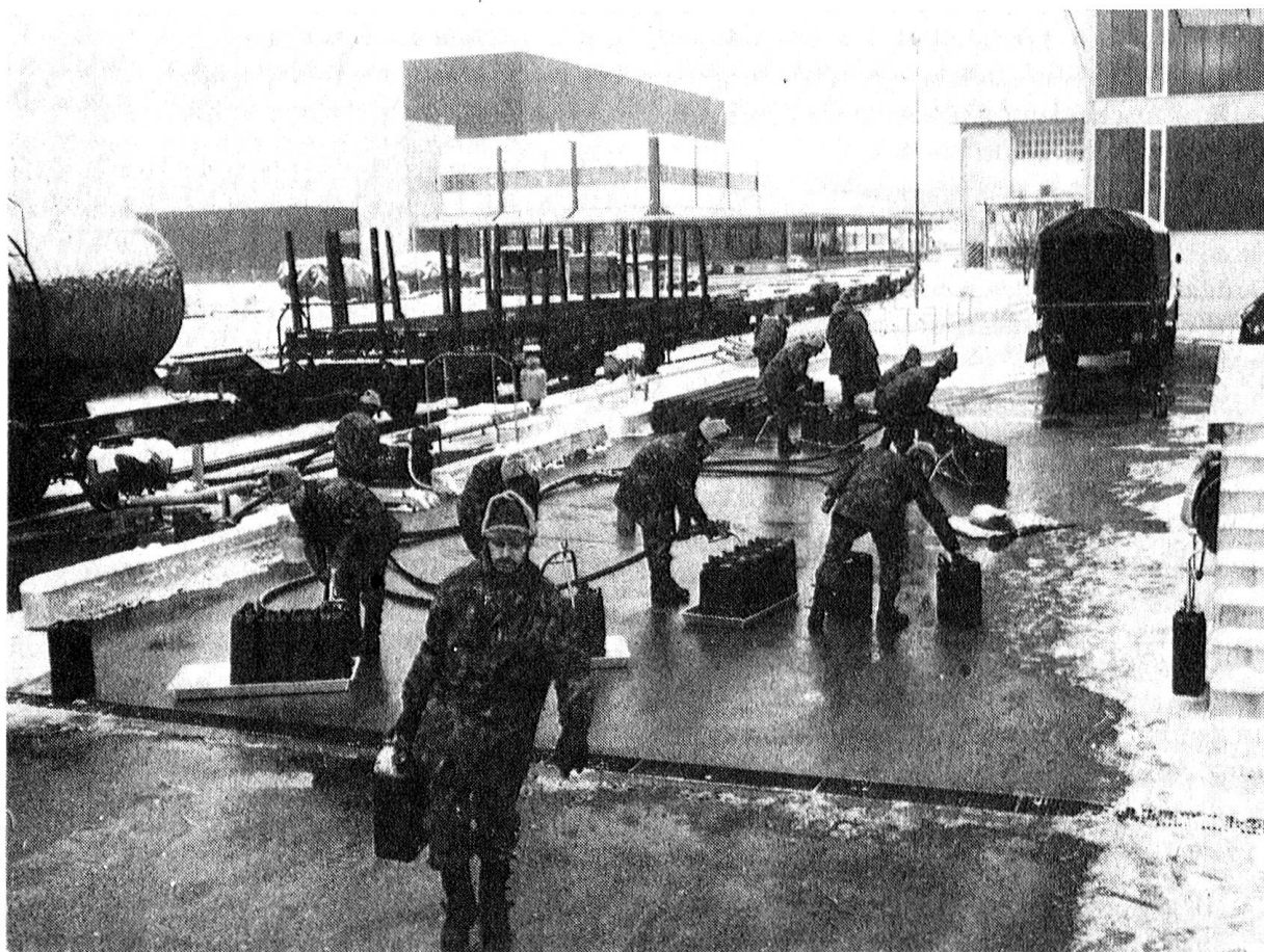
Umschlagplatz von Eisenbahnzisterne in Kanister mit feldmässiger Abfülleinrichtung durch Angehörige der Panzer-Dienst-Kompanie (mech Formationen). Fotos: OKK
