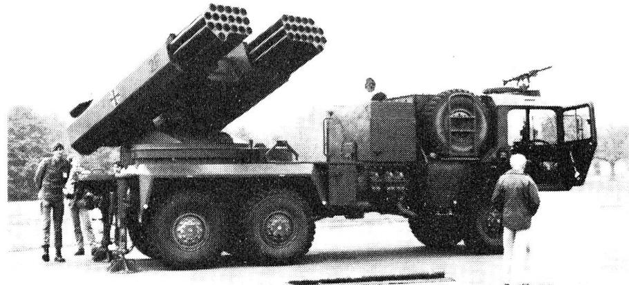
Raketenartillerie: Hier ein Mehrfachraketenwerfer 110 mm.
