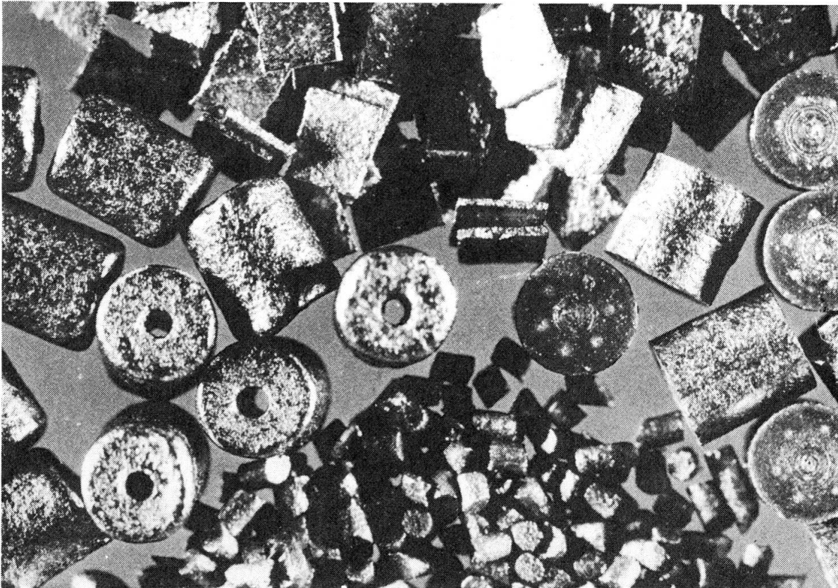
P+F: Kurzgeschnittene Nitrocellulose-Treibladungspulver in verschiedenen Geometrien
