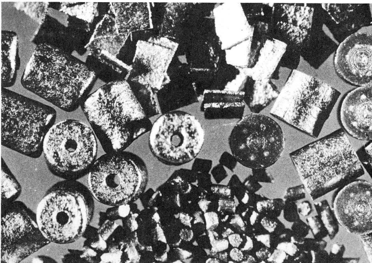
P+F: Kurzgeschnittene Nitrocellulose-Treibladungspulver in verschiedenen Geometrien
