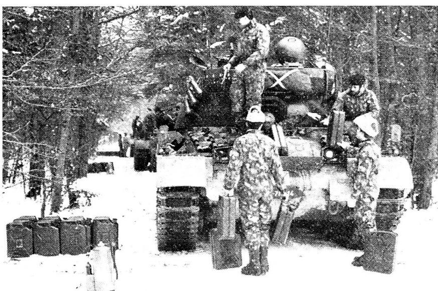
Die gefechtsmässige Betriebsstoffabgabe an «Grossverbraucher» kann entweder ab vorbereiteten Kanisterstapeln die das gleichzeitige, dezentralisierte Betanken erlauben, erfolgen, oder . . .
