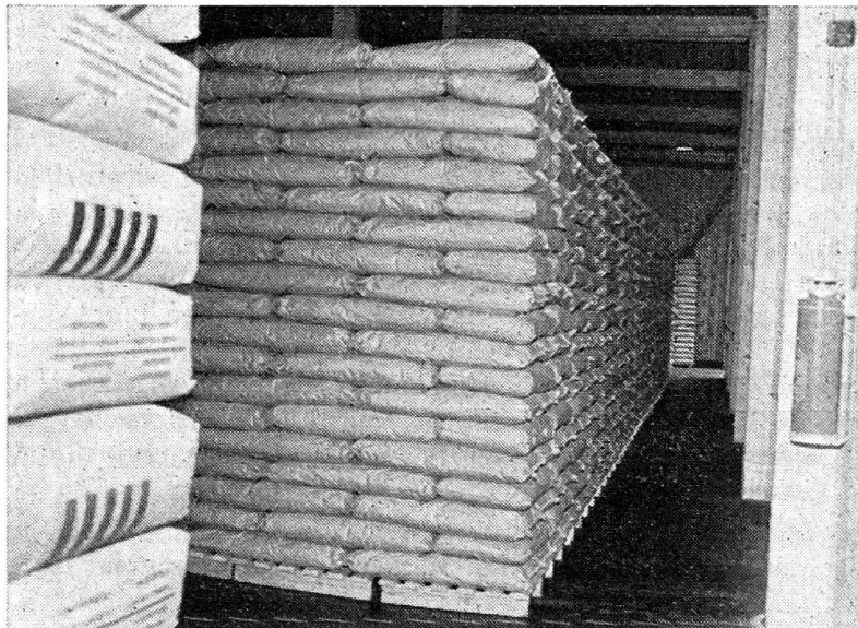
Artikel mit wenig Lager- bewegung werden auf Holz- rosten gelagert.
