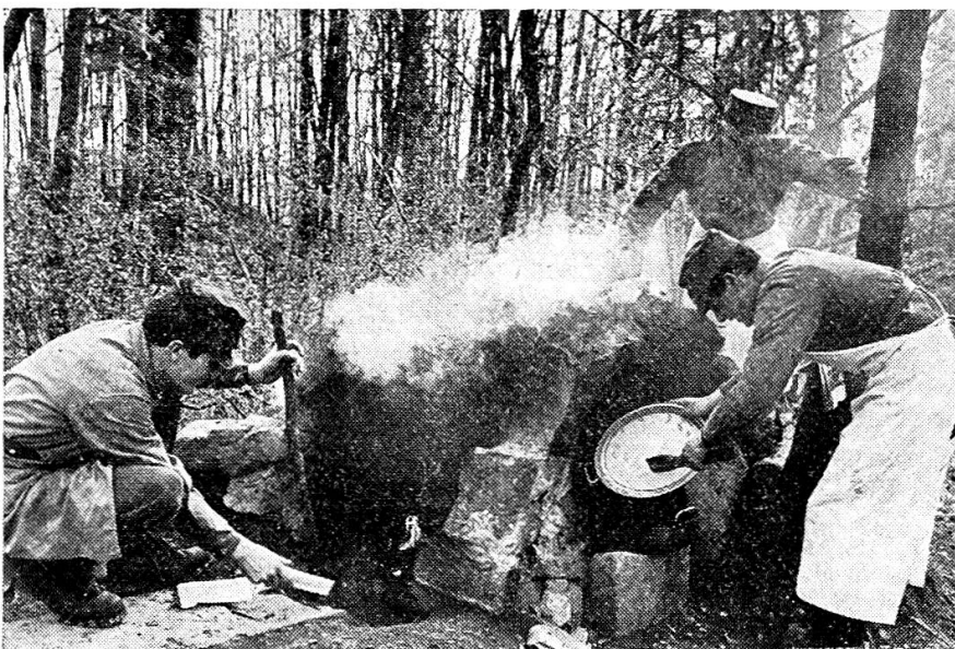
Der «Korea-Ofen», eine aus einem Blechfass und Erde gebastelte Feuerstelle, die erstaunlich leistungsfähig ist und sofort wieder ver- nichtet werden kann.
