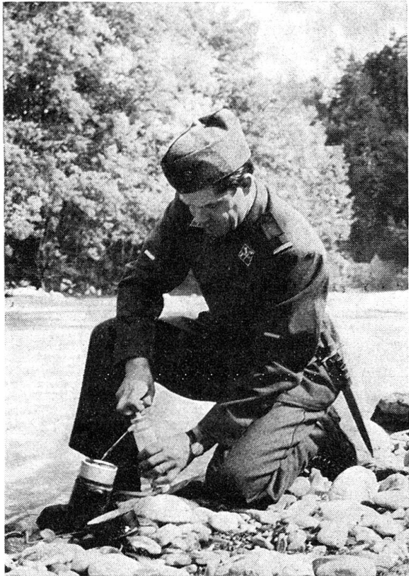
Kleines Wasseraufbereitungsgerät (Leistung ca. 30 l / h)
