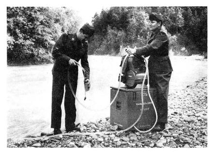
Mittleres Wasseraufbereitungsgerät (Leistung ca. 200 l / h)
