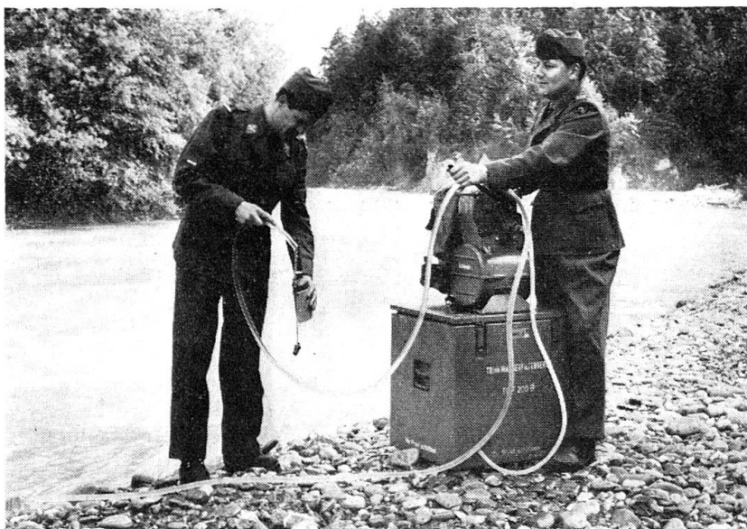
Mittleres Wasseraufbereitungsgerät (Leistung ca. 200 l / h)
