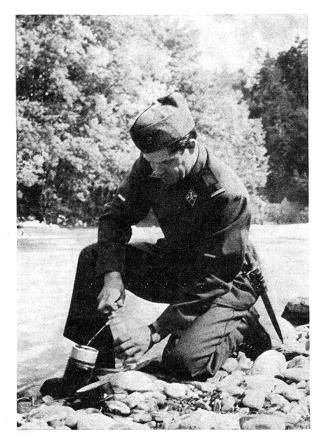
Kleines Wasseraufbereitungsgerät (Leistung ca. 30 | / h)
