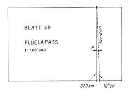
Dieser Winkel, der in der Nähe des Kartennullpunktes Bern nahezu Null ist und gegen West und Ost erheblich ansteigt, heisst Meridiankonvergenz und ist eine Folge der Abbildung auf den schief angelegten Zylinder. Analog sind die von links nach rechts laufenden Breitenkreise gegen die Horizontale gekippt.
