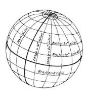
Um Landkarten herstellen zu können, muss die kugelförmig gekrümmte, nicht in eine Ebene ausbreit- oder abwickelbare Erdoberfläche auf die Kartenebene abgebildet werden. Als ebene, nicht-gekrümmte Fläche gilt nun in der Geometrie auch der Zylindermantel. Obschon er beim ersten Anblick als gekrümmt erscheint, kann er längs einer Mantellinie aufgeschnitten und ohne weiteres in die Ebene ausgebreitet werden, er ist also im Prinzip eben:
