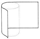
Für unsere Landeskarten wird die kugelförmige Erdoberfläche auf einen solchen Zylindermantel abgebildet, der dann als aufgeschnitten und in die Ebene ausgebreitet gedacht werden kann. Der Zylinder liegt dabei schief zur Erdachse, und zwar so, dass sein Mantel die Erdkugel in der Schweiz am besten berührt:
