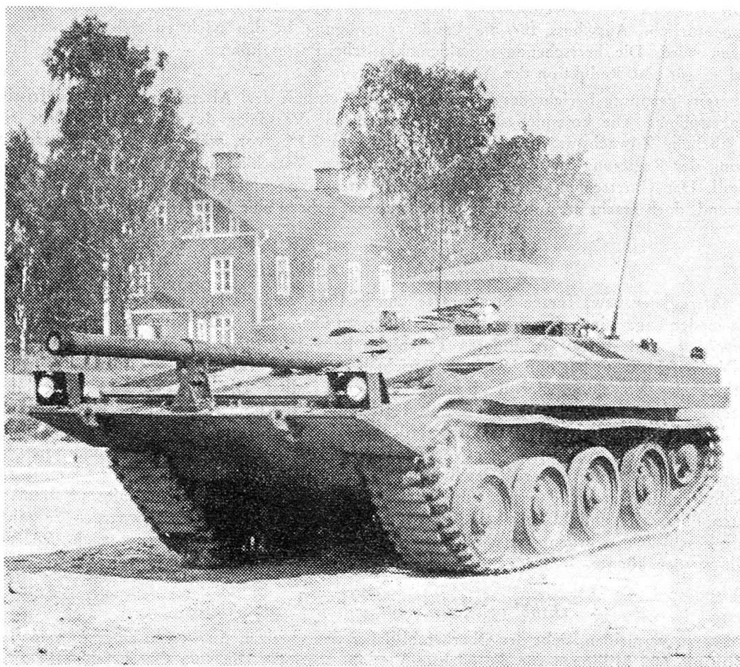
Zu den spektakulärsten Neukonstruktionen unter den Raupenfahrzeugen der letzten Jahre zählt der von AB Bofors gebaute turmlose Panzer «S».
