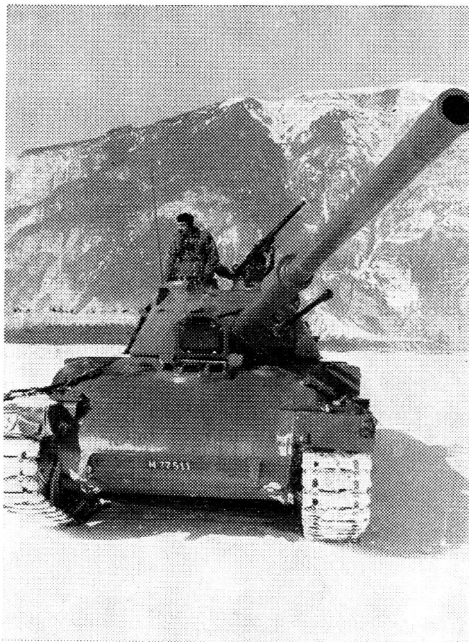
Der Panzer 61 mit seiner drohenden 10,5 cm Kanone, der rohrparallelen 20 mm Maschinenkanone und dem 7,5 mm Mg. 51 auf dem Turm.
