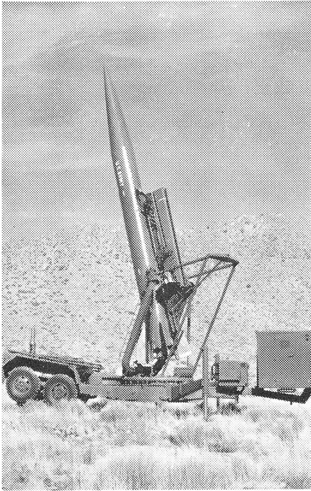
Die Feststoff-Rakete «Sergeant» unmittelbar vor dem Abschuss. Sobald die Vorbereitungen abgeschlossen sind, nimmt der Flugkörper automatisch die Abgangsrichtung ein. Die Waffe kann mit einer atomaren Ladung bis 136 Kilometer weit fliegen Photo: Interavia
